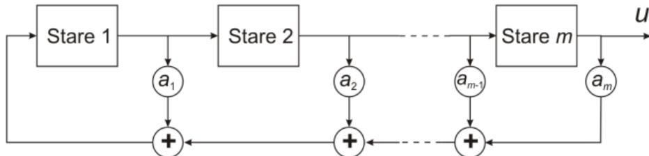
SPAB poate fi generat cu un **registru de deplasare cu reacție liniară** (en. *linear shift feedback register*, LSFR), reprezentat în figură. Toate semnalele și toți coeficienții sunt binari (stările sunt biți).
